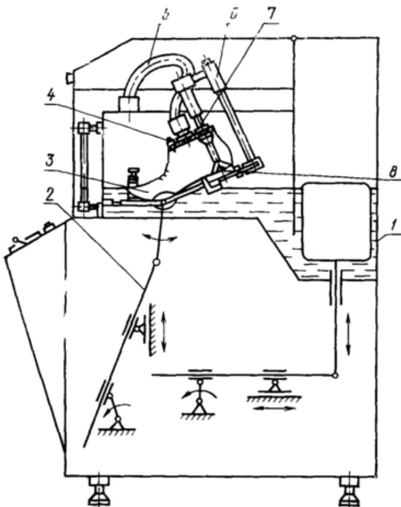
колодка вместе с обувью прижимается к подвижной плате 8, нипель 4 и пучок проводов с разъемом 5. С помощью соединительных кабелей контактная колодка подключается к сигнальной установке. Контакты из токопроводящей резины, размещенные в определенных участках поверхности колодки, с сигнальным устройством обеспечивают испытание водостойкости различных участков обуви.
